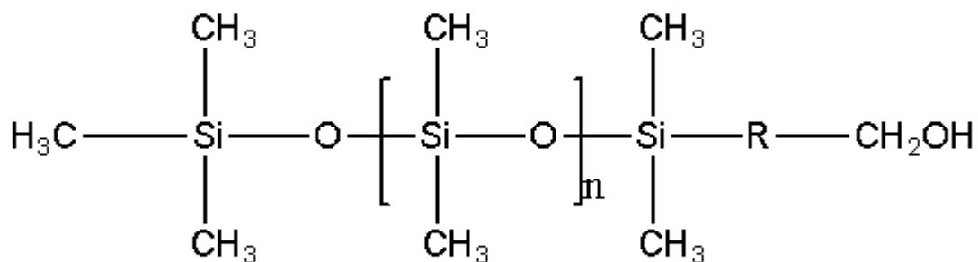
**特点 :**单端羟丙基硅油 , 一端为有机硅基团 , 一端为羟丙基基团 , 分别兼顾了有机硅手感特性和防涂鸦特性 , 比普通的双端羟丙基具有更好的手感和防涂鸦效果。
